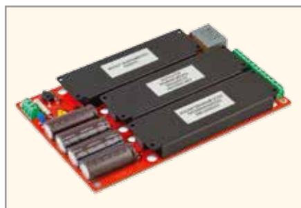
Рис. 13. Низкопрофильная ( h = 16,5\text{ мм} ) AC/DC-система электропитания мощностью 340 Вт, построенная из унифицированных модулей
