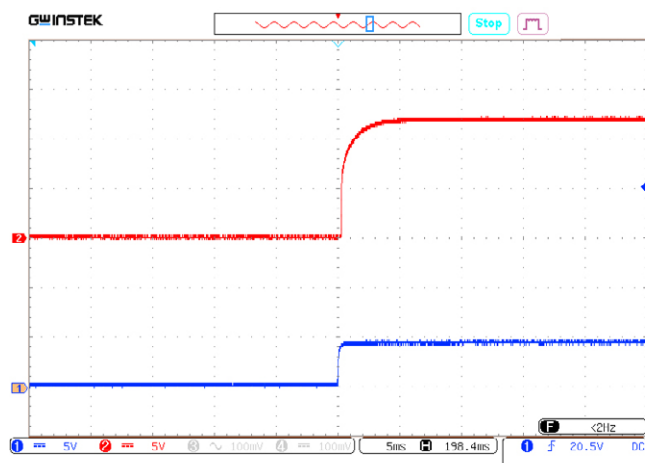
Рис. 22. Осциллограмма установления выходного напряжения с момента подачи команды дистанционного управления.
