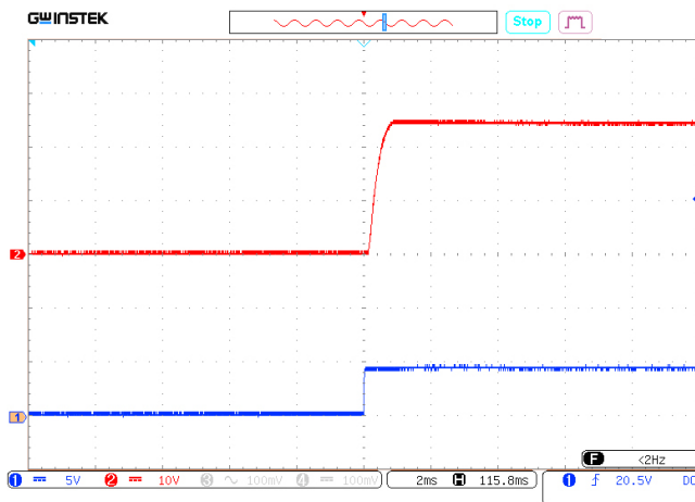
Рис. 26. Осциллограмма установления выходного напряжения с момента подачи команды дистанционного управления. Луч 1 (синий) – напряжение на выводе «ВКЛ». Масштаб 5 В/дел. Луч 2 (красный) – выходное напряжение. Масштаб 10 В/дел. Развертка 2 мс/дел.
