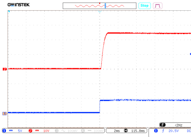
Рис. 26. Осциллограмма установления выходного напряжения с момента подачи команды дистанционного управления. Луч 1 (синий) – напряжение на выводе «VKЛ». Масштаб 5 В/дел. Луч 2 (красный) – выходное напряжение. Масштаб 10 В/дел. Развертка 2 мс/дел.
