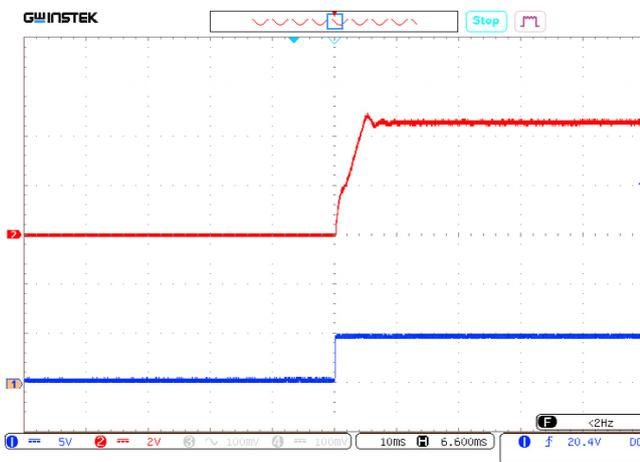
Рис. 19. Осциллограмма установления выходного напряжения с момента подачи команды дистанционного управления.
