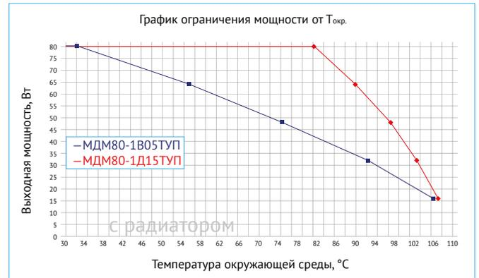
Рис. 18. График ограничения мощности от  $T_{окр.}$  с применением радиатора БКЯЮ.752694.264-01 ( $S=383 \text{ см}^2$ ).
