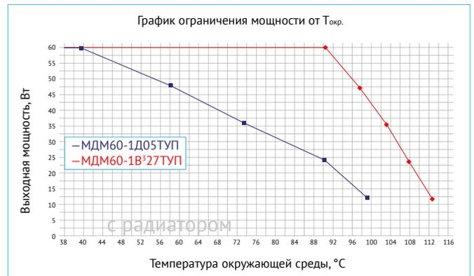
Рис. 16. График ограничения мощности от  $T_{окр}$ . с применением радиатора БКЯЮ.752694.264-01 (S=383 см²).
