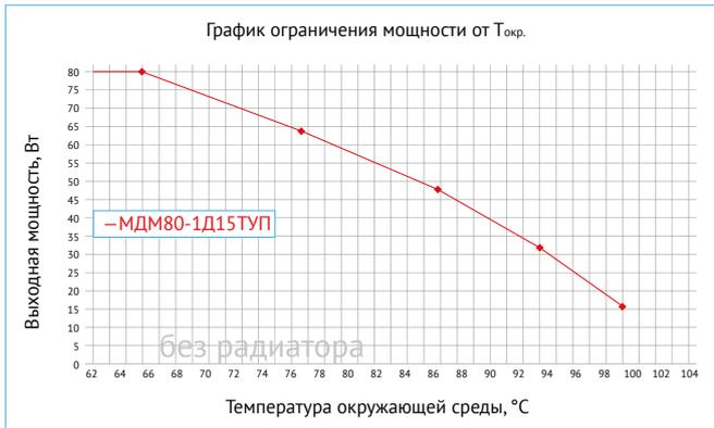
Рис. 17. График ограничения мощности от  $T_{окр.}$  без применения внешнего радиатора.
