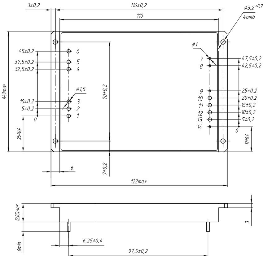
Рис. 21. Модуль одноканальный в корпусе с фланцами (индекс «У»).
