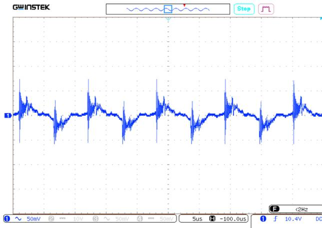
Рис. 20. Осциллограмма пульсаций выходного напряжения.
