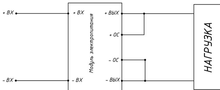
Рис. 12. Схема включения выносной ОС в случае, когда функция выносной ОС не используется.
