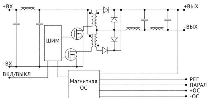
Рис. 1. Функциональная схема МДМ240-П, МДМ320-П, МДМ400-П, МДМ500-П.
