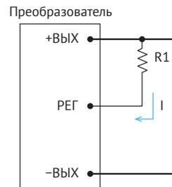
Рис. 9. Снижение  $U_{\text{вых}}$ .
