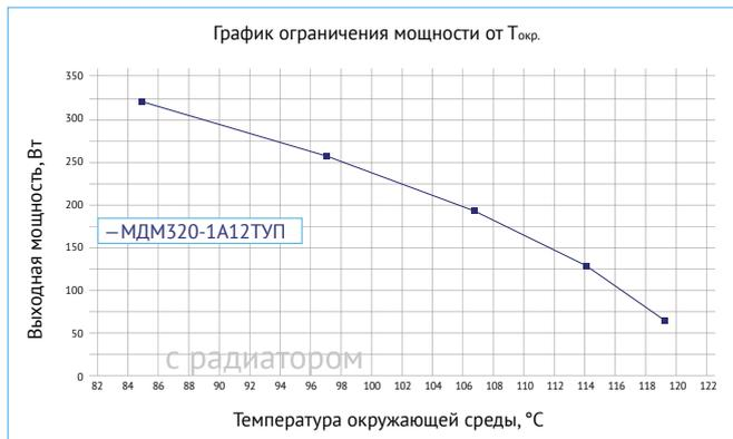
Рис. 16. График ограничения мощности от  $T_{окр.}$  с применением радиатора БКЯЮ.752695.266-01 ( $S=901 \text{ см}^2$ ) с принудительным обдувом, скорость воздушного потока 2,5 м/с. Для разных исполнений модулей.
