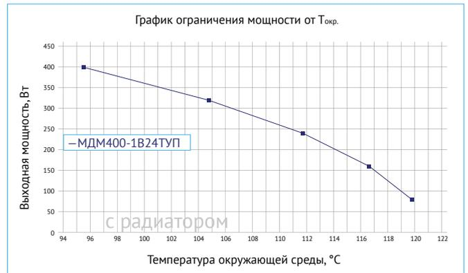
Рис. 17. График ограничения мощности от  $T_{окр.}$  с применением радиатора БКЯЮ.752695.266-01 ( $S=901 \text{ см}^2$ ) с принудительным обдувом, скорость воздушного потока 2,5 м/с. Для разных исполнений модулей.
