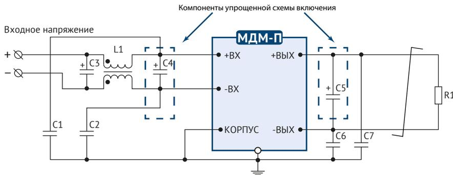
Конденсатор C4 является обязательным элементом схемы включения
