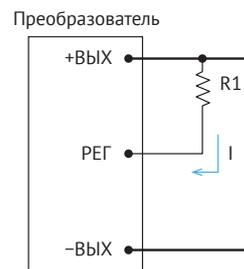
Рис. 9. Снижение  $U_{вых}$ .
