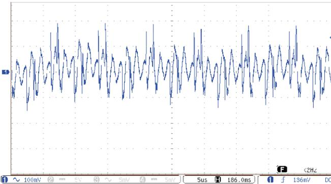
Рис. 19. Осциллограмма пульсаций выходного напряжения.
