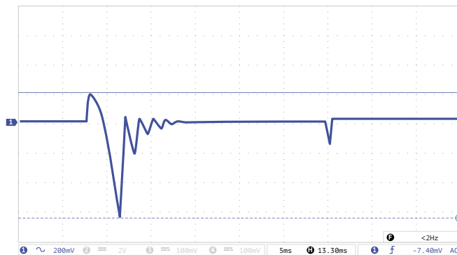
Рис. 15. Осциллограмма переходного отклонения выходного напряжения при изменении выходного тока с 10% до 100 %.
