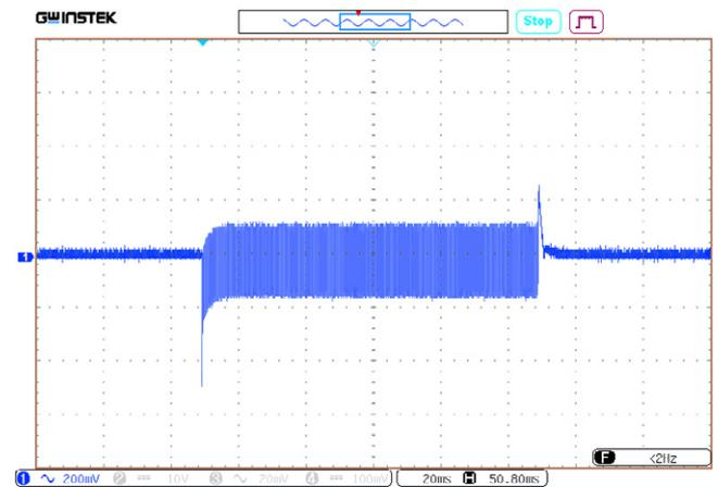
Рис. 61. Осциллограмма переходного отклонения выходного напряжения при изменении выходного тока от 0 до 100%.
