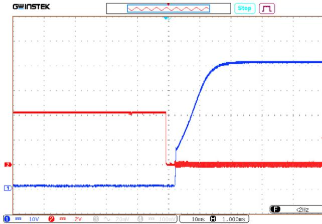
Рис. 58. Осциллограмма установления выходного напряжения с момента подачи команды дистанционного управления.
