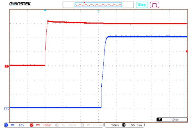
Рис. 55. Осциллограмма установления выходного напряжения с момента подачи входного напряжения.
