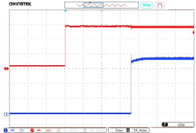
Рис. 47. Осциллограмма установления выходного напряжения с момента подачи входного напряжения.
