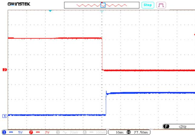
Рис. 46. Осциллограмма установления выходного напряжения с момента подачи команды дистанционного управления.
