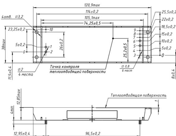
Рис. 77. Модуль МДМ340-А, МДМ500-А, индекс корпусного исполнения «У».
