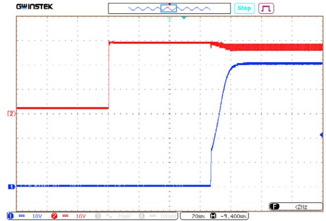
Рис. 59. Осциллограмма установления выходного напряжения с момента подачи входного напряжения.
