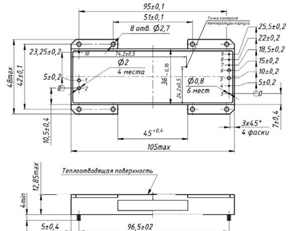
Рис. 78. Модуль МДМ340-А, МДМ500-А, индекс корпусного исполнения «Д».
