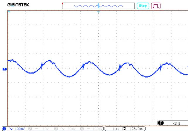
Рис. 60. Осциллограмма пульсаций выходного напряжения.
