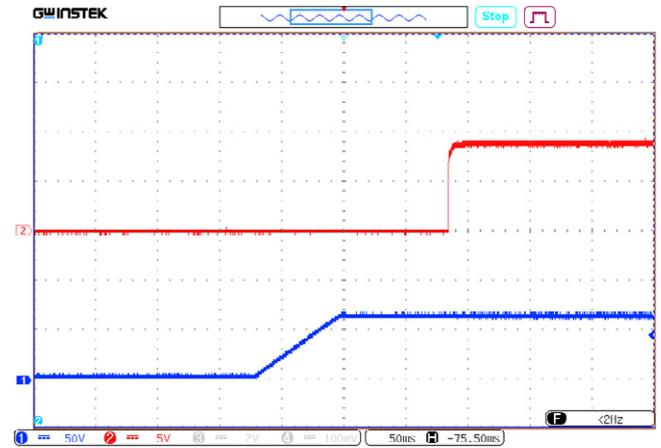
Рис. 51. Осциллограмма установления выходного напряжения с момента подачи входного напряжения.
