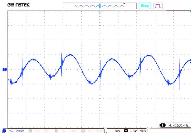
Рис. 48. Осциллограмма пульсаций выходного напряжения.
