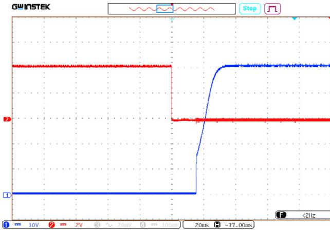
Рис. 54. Осциллограмма установления выходного напряжения с момента подачи команды дистанционного управления.
