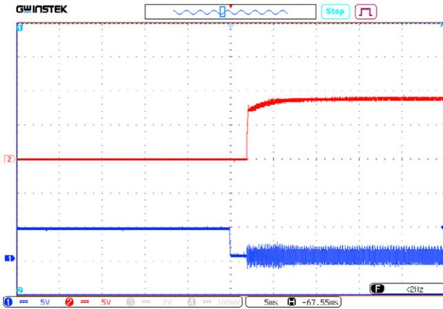
Рис. 50. Осциллограмма установления выходного напряжения с момента подачи команды дистанционного управления.
