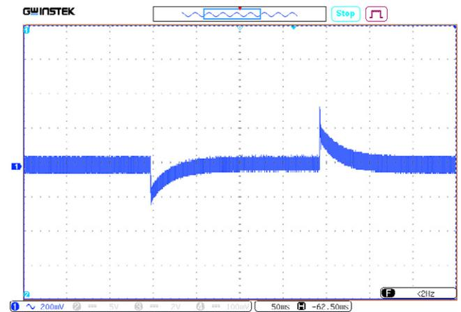
Рис. 53. Осциллограмма переходного отклонения выходного напряжения при изменении выходного тока от 0 до 100%.
