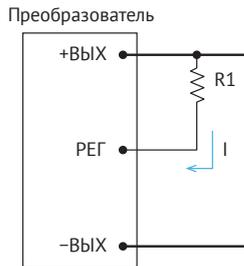
Рис. 4. Снижение  $U_{\text{вых}}$ .
