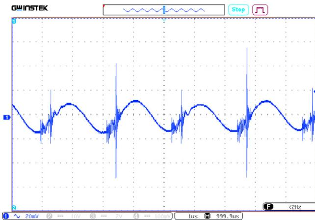
Рис. 52. Осциллограмма пульсаций выходного напряжения.
