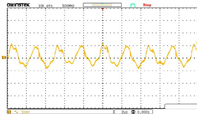
Рис. 44. Осциллограмма пульсаций выходного напряжения.
