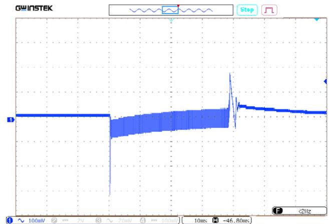
Рис. 49. Осциллограмма переходного отклонения выходного напряжения при изменении выходного тока от 0 до 100%.
