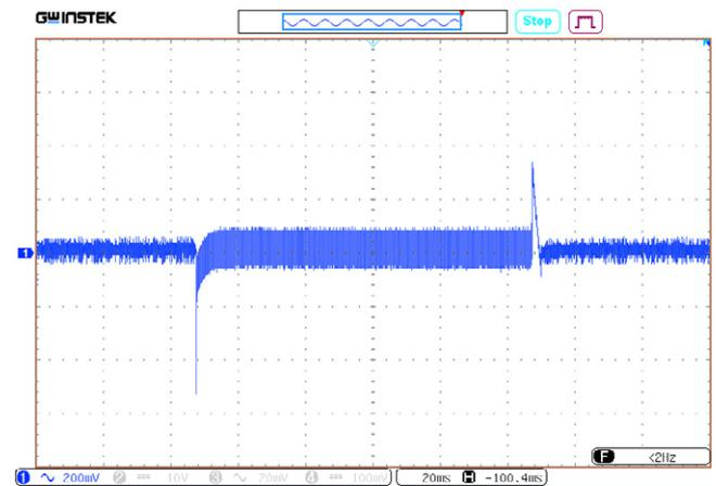
Рис. 57. Осциллограмма переходного отклонения выходного напряжения при изменении выходного тока от 0 до 100%.
