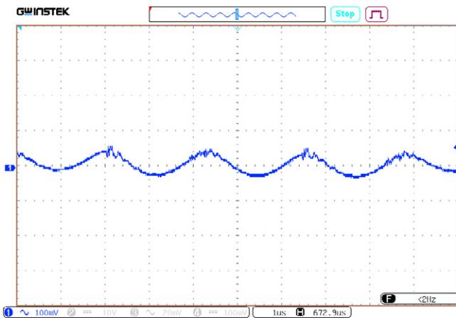
Рис. 56. Осциллограмма пульсаций выходного напряжения.
