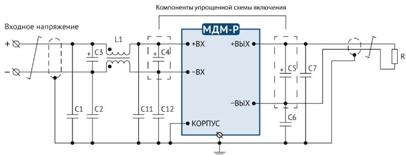
Конденсатор C4 является обязательным элементом схемы включения
