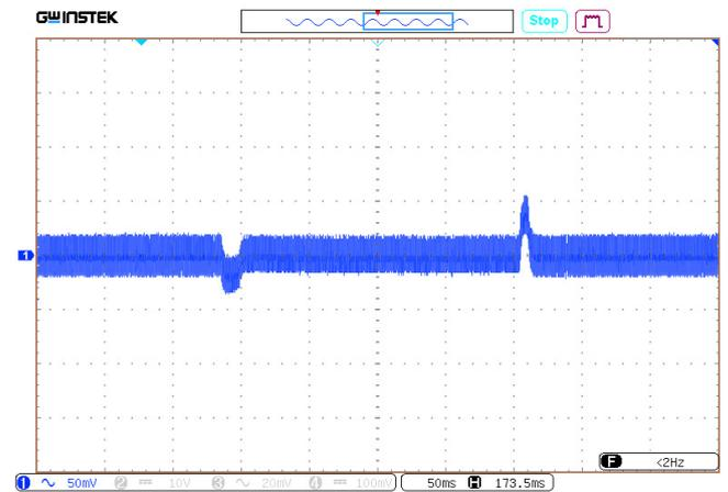
Рис. 54. Осциллограмма переходного отклонения выходного напряжения при изменении выходного тока с 50% до 100%.
