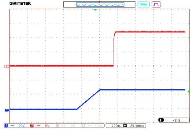
Рис. 48. Осциллограмма установления выходного напряжения с момента подачи входного напряжения.
