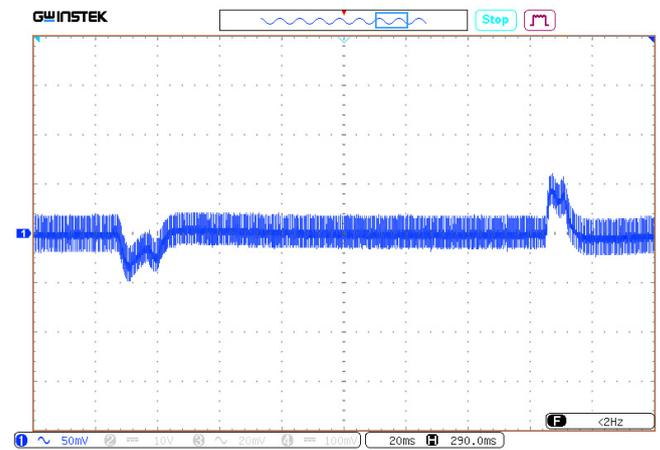
Рис. 50. Осциллограмма переходного отклонения выходного напряжения при изменении выходного тока с 50% до 100%.
