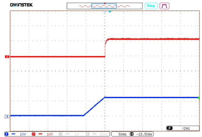
Рис. 52. Осциллограмма установления выходного напряжения с момента подачи входного напряжения.
