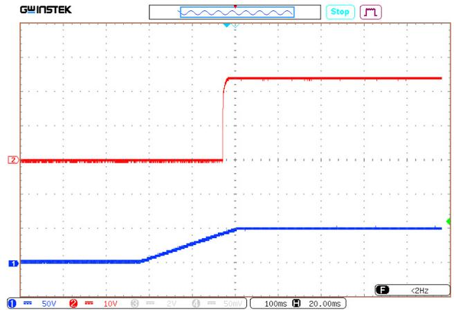
Рис. 60. Осциллограмма установления выходного напряжения с момента подачи входного напряжения.
