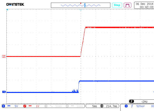
Рис. 26. Осциллограмма установления выходного напряжения с момента подачи команды дистанционного управления.
