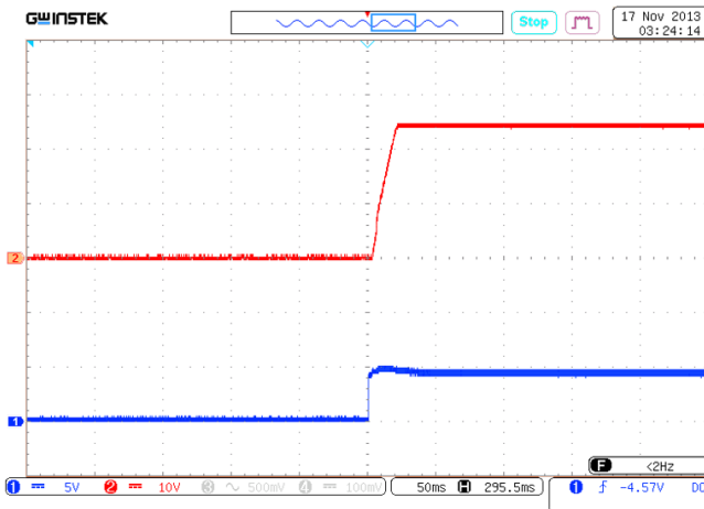
Рис. 31. Осциллограмма установления выходного напряжения с момента подачи команды дистанционного управления. Луч 1 (синий) – напряжение на выводе «ВКЛ». Масштаб 5 В/дел. Луч 2 (красный) – выходное напряжение. Масштаб 10 В/дел. Развертка 50 мс/дел.
