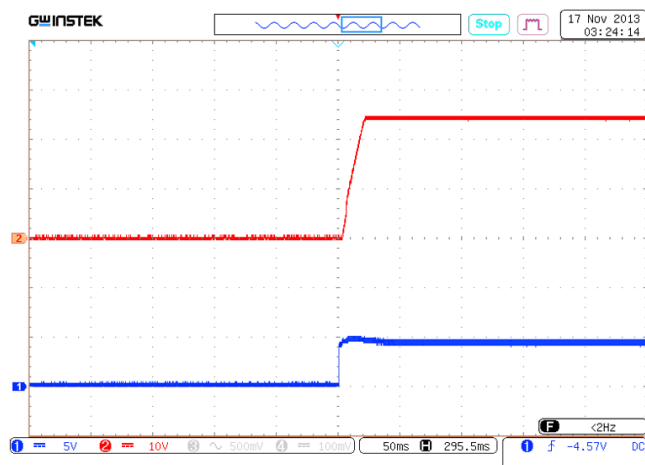
Рис. 31. Осциллограмма установления выходного напряжения с момента подачи команды дистанционного управления.
