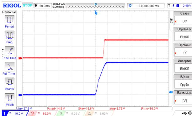
Рис. 18. Установление  $U_{вх,НОМ}$  с момента подачи  $U_{вх,НОМ}$ . Луч 1 (синий) – входное напряжение. Масштаб 10 В/дел. Луч 2 (красный) – выходное напряжение. Масштаб 10 В/дел. Развертка 50 мс/дел.
