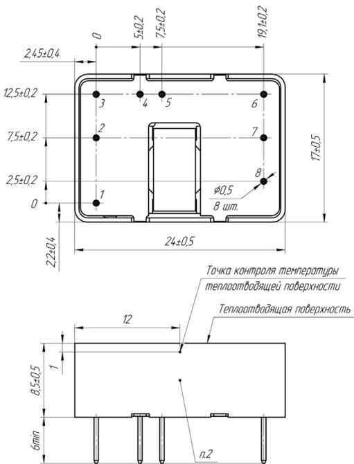
Рис. 12. Двухканальное исполнение в корпусе с фланцами.
