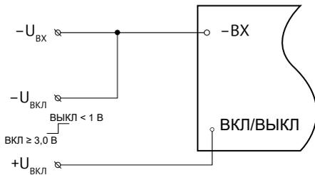
Рис. 4. Управление логическим напряжением.
