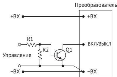
Рис. 6. «ДУ» с помощью биполярного транзистора.
