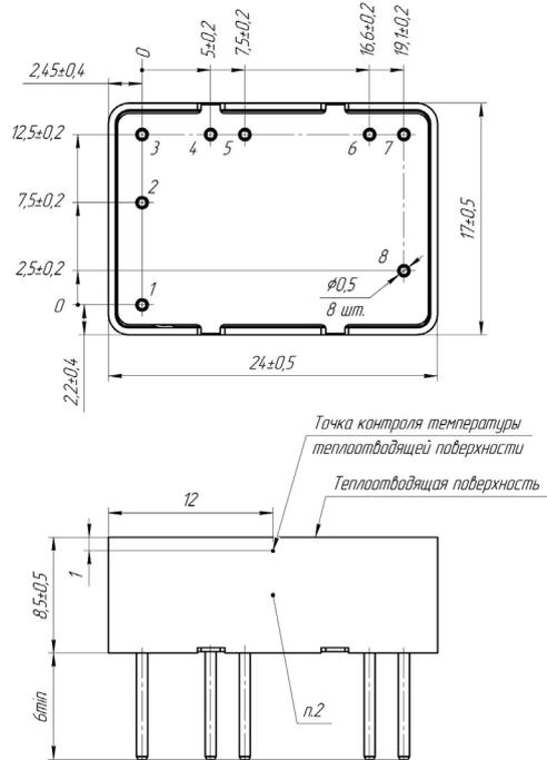
Рис. 11. Одноканальное исполнение в корпусе с фланцами.
