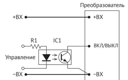
Рис. 6. «ДУ» с помощью оптрона.
