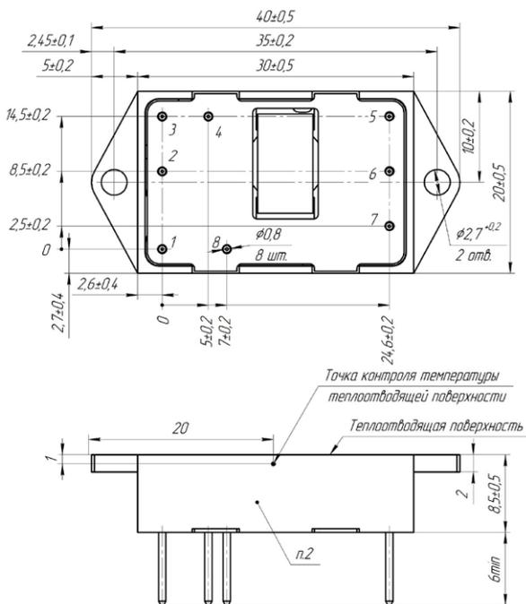
Рис. 11. Двухканальное исполнение в корпусе с фланцами.
