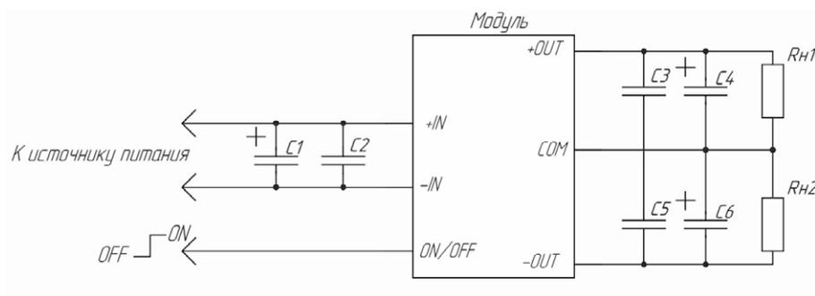
Рис. 2. Типовая схема подключения для двухканального исполнения.
