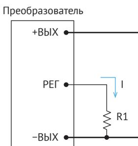
Рис. 7. Регулировка увеличением  $U_{вых}$ .
