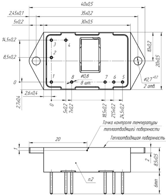
Рис. 10. Одноканальное исполнение в корпусе с фланцами.
