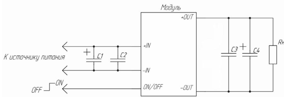
Рис. 1. Типовая схема подключения для одноканального исполнения.
