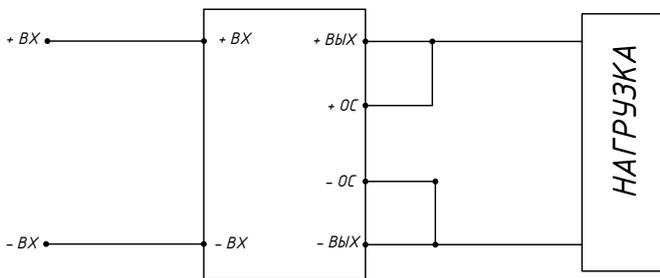
Рис. 12. Типовая схема включения без использования выносной ОС.
