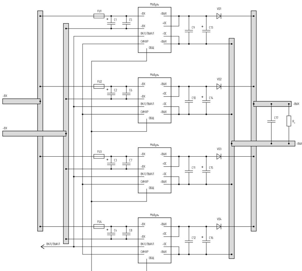
Рис. 13. Схема подключения модулей электропитания для параллельной работы
