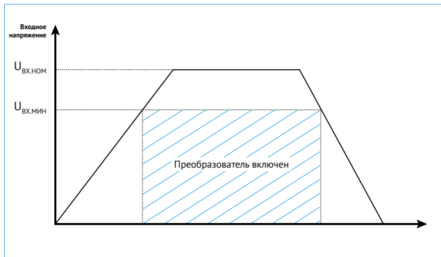
Рис. 4. Пример алгоритма работы защиты от пониженного напряжения.
