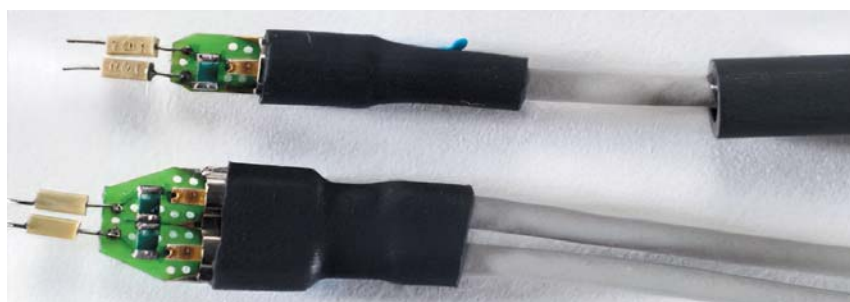
Рис. 3. Несимметричная (вверху) и дифференциальная (внизу) впаиваемые головки крупным планом
