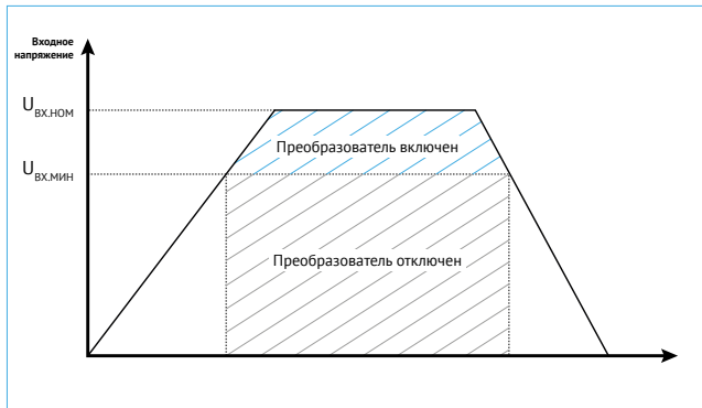
Рис. 4. Пример алгоритма работы защиты от пониженного напряжения.
