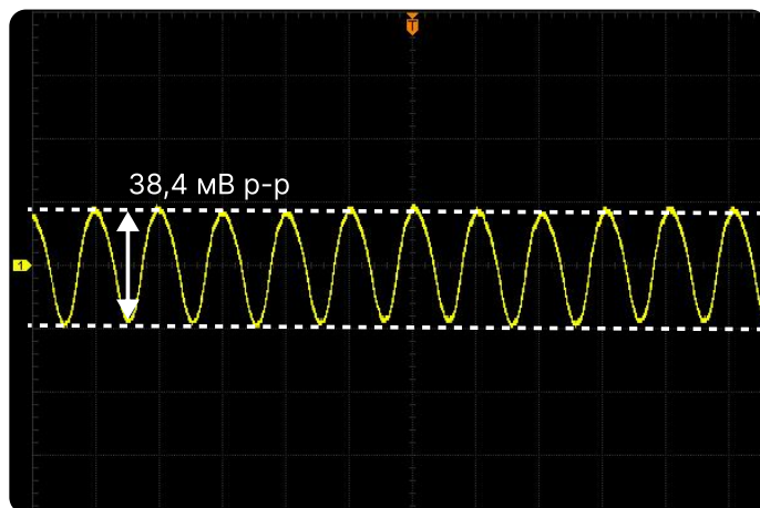
Рис. 6. Осциллограммы пульсаций выходного напряжения модуля U_{\text{вых}} = -15 \text{ В} (Масштаб 20 мВ/дел)
