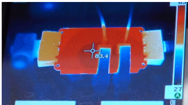
Рис. 9. Измерения T_{\text{корп}} для алюминиевого корпуса модуля с покрытием МДО. Бесконтактный метод - тепловизор.
