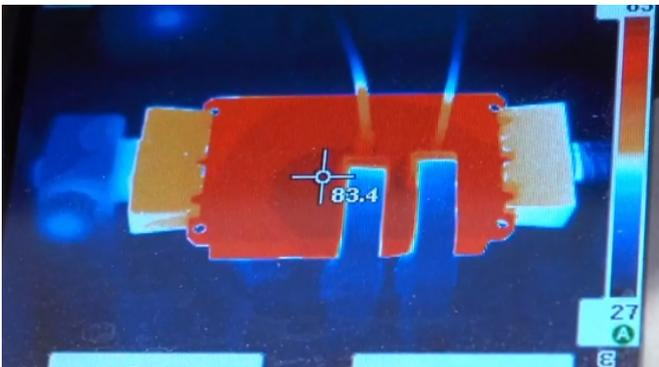
Рис. 9. Измерения  $T_{корп}$  модуля из алюминия с покрытием МДО. Бесконтактный метод - тепловизор.
