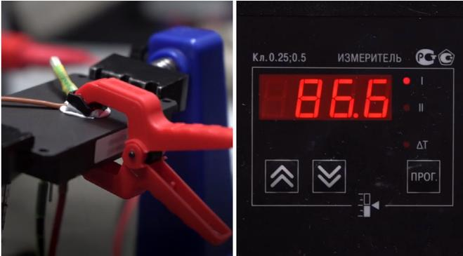
Рис. 8. Измерения  $T_{корп}$  модуля из алюминия с покрытием МДО. Контактный метод.
