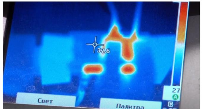
Рис. 11. Измерения  $T_{корп}$  модуля из меди с покрытием хим. никель. Бесконтактный метод - тепловизор.
