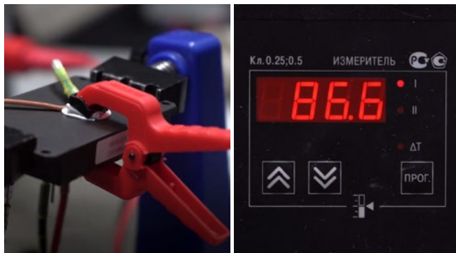
Рис. 8. Измерения T_{\text{корп}} для алюминиевого корпуса модуля с покрытием МДО. Контактный метод.
