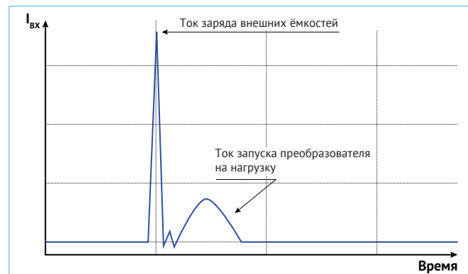
Рис. 8. Возможная форма пускового тока в схеме питания.
