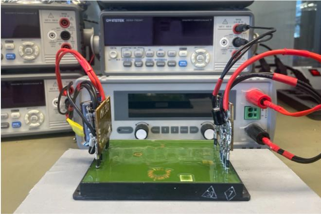
Рис. 5. Аккуратное подключение, параллельное или перпендикулярное расположение проводов.
