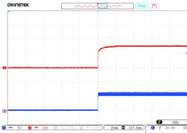
Рис. 25. Осциллограмма установления выходного напряжения с момента подачи команды дистанционного управления.
