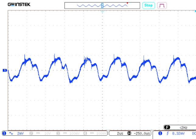
Рис. 31. Осциллограмма пульсаций выходного напряжения.
