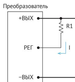
Рис. 10. Снижение  $U_{\text{вых}}$ .
