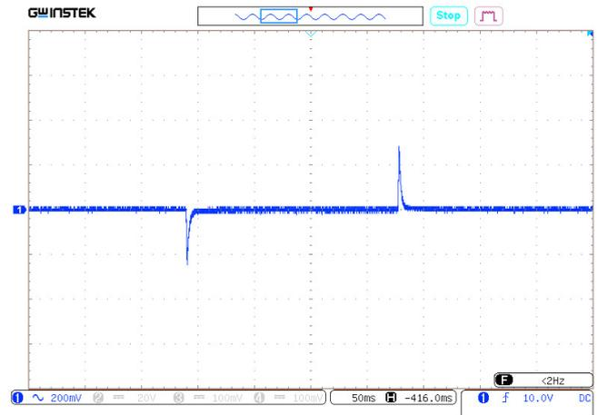
Рис. 24. Осциллограмма переходного отклонения выходного напряжения при изменении выходного тока с 50% до 100%.
