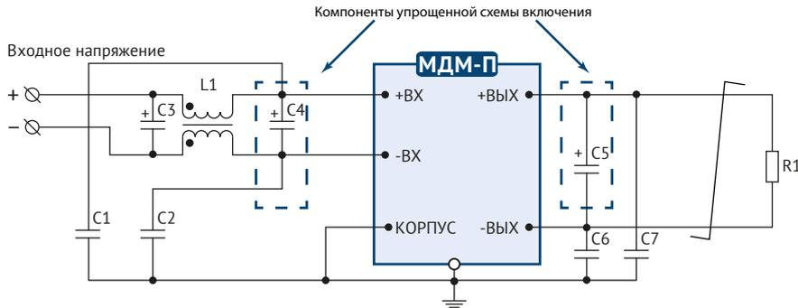
Конденсатор C4 является обязательным элементом схемы включения
