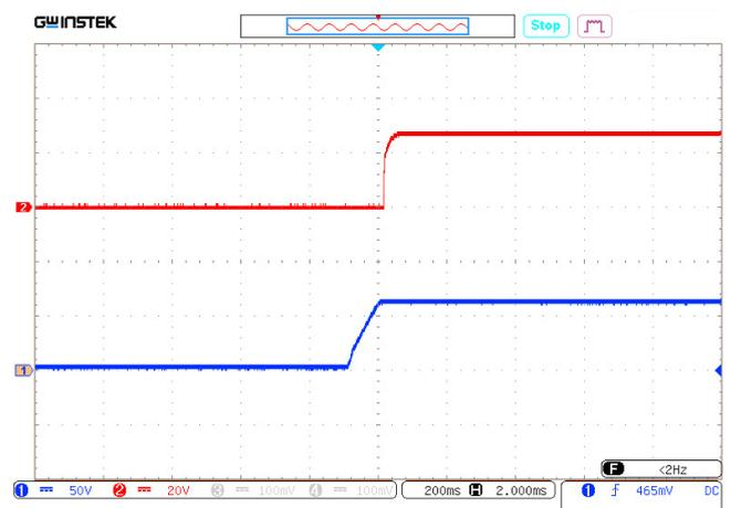
Рис. 30. Осциллограмма установления выходного напряжения с момента подачи входного напряжения.
