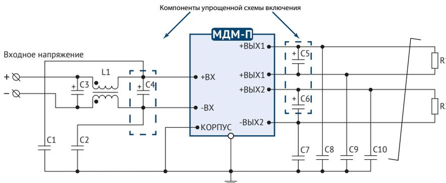
Конденсатор C4 является обязательным элементом схемы включения
