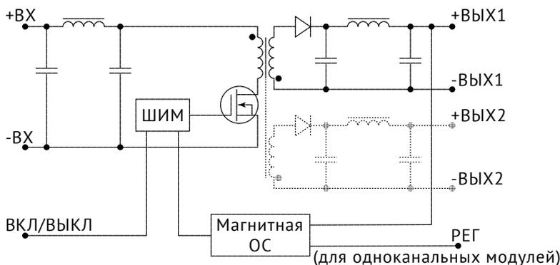
Рис. 1. Функциональная схема МДМ3-П, МДМ5-П, МДМ6-П, МДМ8-П.
