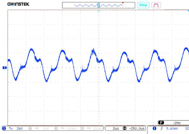
Рис. 27. Осциллограмма пульсаций выходного напряжения.
