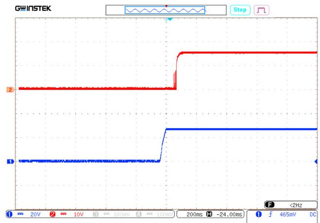
Рис. 26. Осциллограмма установления выходного напряжения с момента подачи входного напряжения.
