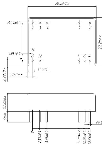
Рис. 35. Модуль одноканальный в корпусе без фланцев.
