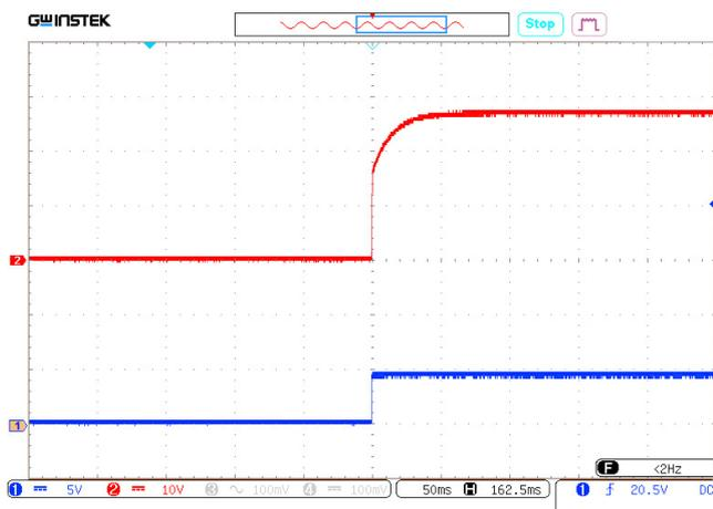
Рис. 29. Осциллограмма установления выходного напряжения с момента подачи команды дистанционного управления.
