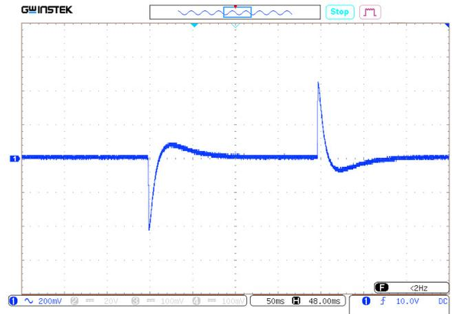
Рис. 28. Осциллограмма переходного отклонения выходного напряжения при изменении выходного тока с 50% до 100%.
