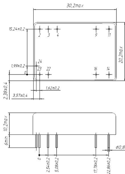
Рис. 37. Модуль двухканальный в корпусе без фланцев.
