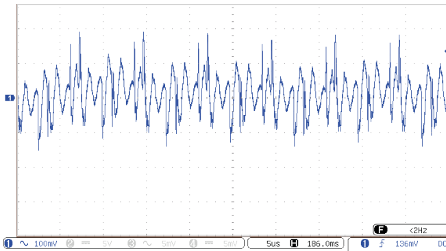
Рис. 19. Осциллограмма пульсаций выходного напряжения. Масштаб 100 мВ/дел. Развертка 1 мкс/дел.
