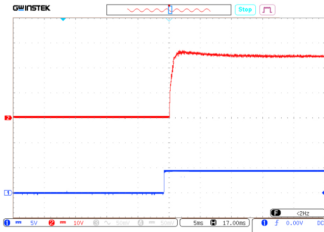
Рис. 13. Осциллограмма установления выходного напряжения с момента подачи команды дистанционного управления.
