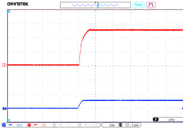
Рис. 40. Осциллограмма установления выходного напряжения с момента подачи команды дистанционного управления.
