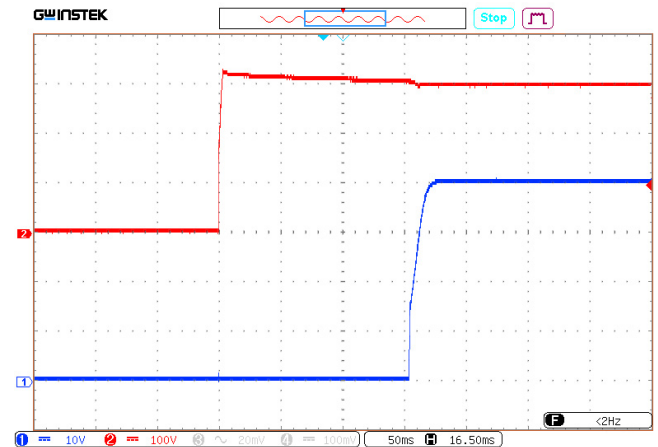
Рис. 39. Осциллограмма установления выходного напряжения с момента подачи входного напряжения.
